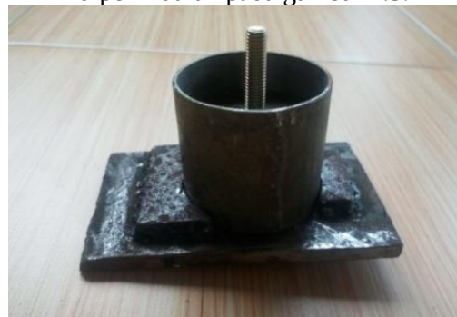
Gambar 10. Rangka Cetakan Roda Skateboard
